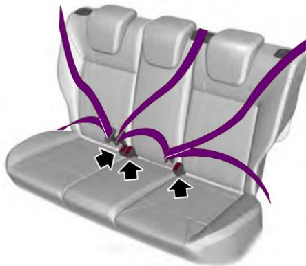
Hale el cinturón de seguridad de manera continua para desenrollarlo. Si hala bruscamente o si el vehículo se encuentra en una pendiente, el cinturón de seguridad puede quedar trabado.
