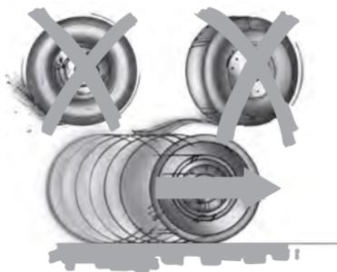
Realice el descenso de una cuesta en la misma marcha que usaría para subirla a fin de evitar el uso excesivo de los frenos y el sobrecalentamiento de estos. No descienda en punto muerto. Mueva la palanca de cambios a un cambio más bajo. Cuando descienda de una cuesta pronunciada, evite frenar de manera brusca ya que puede perder el control del vehículo. Las ruedas delanteras tienen que girar para poder maniobrar el vehículo.
