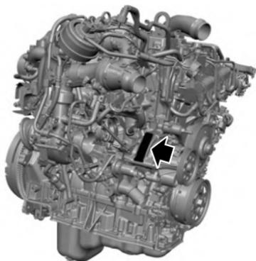
El grabado del número de secuencia del motor se encuentra en la esquina delantera derecha del bloque de cilindros.
