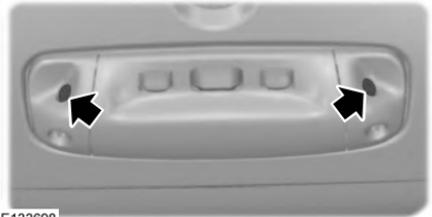
Los sensores sirven para disuadir el acceso no autorizado al detectar cualquier movimiento dentro del vehículo.
