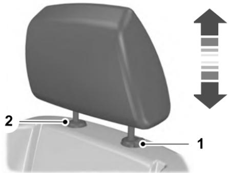
Hale hacia arriba el apoyacabeza. Presione el botón 1 de bloqueo y al mismo tiempo, libere la traba 2 de retención con una herramienta adecuada. Hale el apoyacabeza hacia arriba, hasta que se libere del respaldo del asiento.
