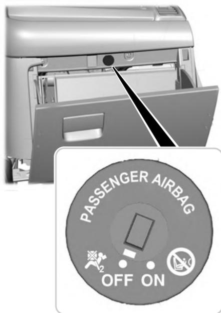
**Nota:** El interruptor de la llave está ubicado en la guantera y tiene una luz de desactivación del airbag en el cuadro de instrumentos.
