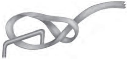
6. Ubique el punto de anclaje de carga cerca del respaldo del asiento. Pase el bucle de la correa de sujeción a través del punto de anclaje. Pase el otro extremo a través del bucle.
