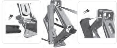
3. Vuelva a colocar el conjunto del kit del gato en la posición original del vehículo y asegúrelo con la tuerca tipo mariposa de plástico. Asegúrese de haber sujetado el gato de manera segura antes de conducir.
