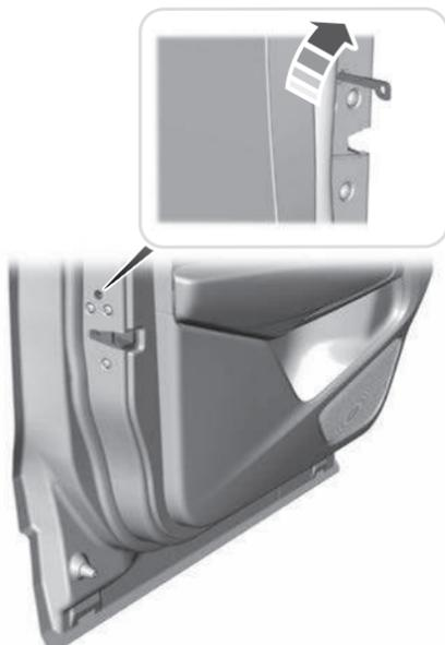
Si la función trabar central no funciona, trabre las puertas una por una con la llave en la posición que se muestra.
