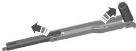
8. Afloje las tuercas de seguridad de las ruedas girando media vuelta hacia la izquierda, pero no las quite hasta que se haya levantado la rueda del suelo.
