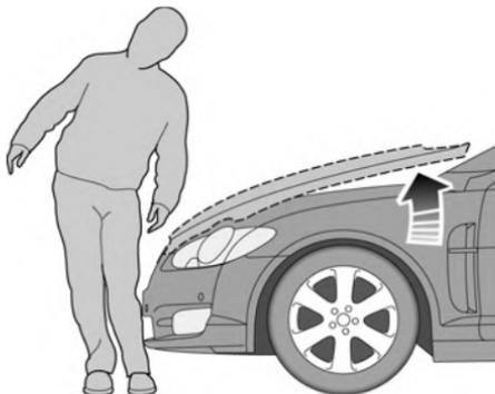
El sistema libera las bisagras del capó y eleva el extremo posterior del capó por aproximadamente 100 mm. Esto aumenta la distancia entre el capó y las piezas dentro del compartimiento del motor para proporcionar amortiguación adicional en caso de que el peatón tenga contacto con el capó.
