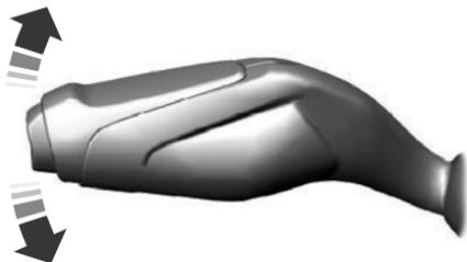
Levante o baje la palanca para usar las luces direccionales.
