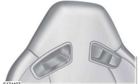
Los apoyacabezas no ajustables consisten en una espuma recortada que cubre la estructura superior del respaldo del asiento.
