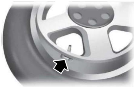
**Nota:** Cada neumático cuenta con un sensor de presión de neumáticos ubicado en la cara interior de la llanta. El sensor de presión está unido al vástago de la válvula. Este sensor está cubierto por el neumático, por lo que no está a la vista a menos que retire el neumático. Tome debida precaución al cambiar los neumáticos para evitar dañar el sensor.
