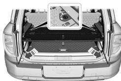
1. Deslice el separador del maletero a la primera posición de fijación.
