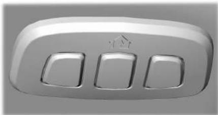
La apertura de puerta de garaje universal reemplaza al garaje manual común con un transmisor de tres botones integrado en la visera solar del conductor.
