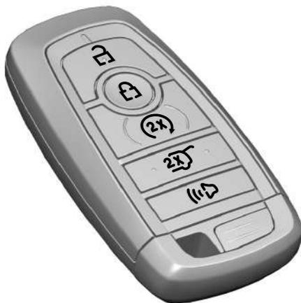
El comando a distancia hace funcionar los seguros eléctricos y el sistema de arranque a distancia. La llave debe estar en el vehículo para poder usar el botón de arranque.
