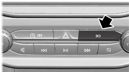
El botón del sistema de la cámara está en la unidad de audio y permite habilitar y deshabilitar la cámara frontal.
