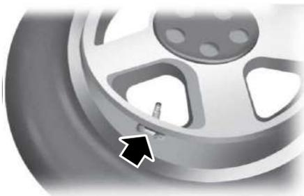
**Nota:** cada neumático cuenta con un sensor de presión de neumáticos ubicado en la cara interior de la rueda. El sensor de presión está unido al vástago de la válvula. Este sensor está cubierto por el neumático, por lo que no está a la vista a menos que retire el neumático. Tome debida precaución al cambiar los neumáticos para evitar dañar el sensor.
