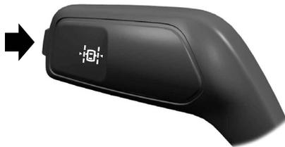
Presione el botón ubicado en la palanca de luces direccionales para activar o desactivar el sistema.
