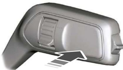
Mueva la palanca alejándola de usted para hacer funcionar el lavaluneta. Al soltar la palanca, el limpiaparabrisas funciona por un breve periodo.
