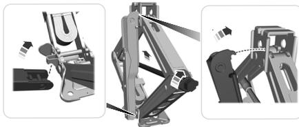
3. Vuelva a colocar el conjunto del kit del gato en la posición original del vehículo y asegúrelo con la tuerca tipo mariposa de plástico. Asegúrese de haber sujetado el gato de manera segura antes de manejar.
