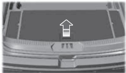
Los vehículos con llanta de repuesto tamaño estándar puede ajustar el piso de carga en dos posiciones. Puede colocar el frente del piso de carga encima, para una posición alta, o debajo, para una posición baja, de los bordes detrás de los asientos traseros. La parte trasera del piso de carga siempre se asienta en los dos pequeños anaqueles de la moldura de la compuerta levadiza.
