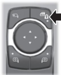
Oprima el control para bloquear o desbloquear los controles de las ventanas traseras. Este se ilumina cuando bloquea los controles de las ventanas traseras.
