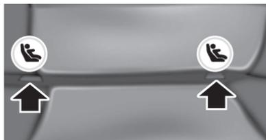
Los anclajes LATCH están en la sección posterior del asiento trasero, entre el cojín y el respaldo del asiento, por debajo de los símbolos que se muestran. Siga las instrucciones del fabricante del asiento para niños para instalar correctamente un asiento para niños con conexiones LATCH.
