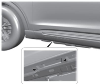
12. Coloque el gato en el punto de apoyo para el gato junto a la llanta que está cambiando. Gire la manija de la llave a la derecha hasta que la llanta desinflada se separe completamente del suelo.
