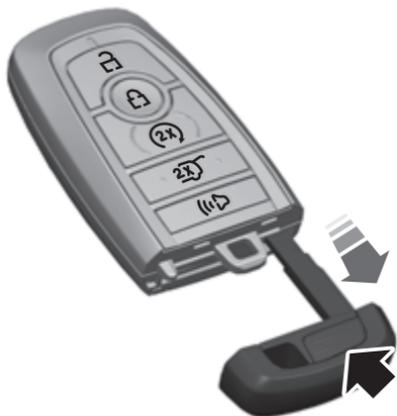
La llave de acceso inteligente acciona los seguros eléctricos y el sistema de arranque remoto. La llave debe estar en el vehículo para usar el sistema de arranque con botón de presión.
