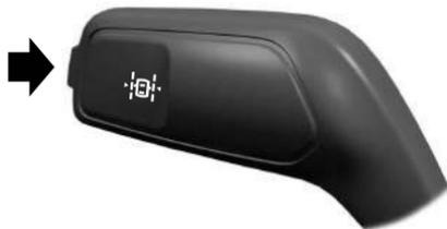
Presione el botón en la palanca indicadora de dirección para encender y apagar el sistema.
