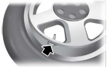
**Nota:** Todas las llantas de uso normal incluyen un detector de presión de la llanta ubicado en el interior de la cavidad del conjunto de rueda y llanta. El sensor de presión está unido al vástago de válvula. La llanta cubre el sensor de presión, por lo que no se puede ver, a menos que quite la llanta. Tenga cuidado cuando cambie las llantas a fin de evitar dañar el sensor.
