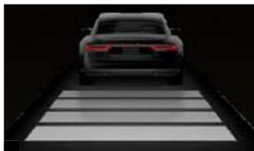
La separación seleccionada aparece en la pantalla del tablero de instrumentos, tal como lo muestran las barras de la imagen.
