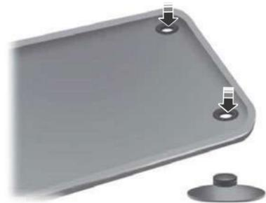
Para instalar los tapetes de piso que tienen ojales, coloque el ojal del tapete sobre el punto de retención y presione hacia abajo para que se fije en el lugar. Repita lo mismo para todos los ojales del tapete.
