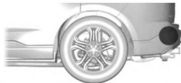
El diseño de la asistencia de frenado en reversa reduce el daño por impacto o ayuda a evitar una colisión al utilizar los sensores en la parte trasera del vehículo para detectar una posible colisión y aplica los frenos. El sistema funciona cuando está en reversa (R) y desplazándose a una velocidad de 1,5–12 km/h.
