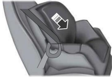
5. Para poner el retractor en el modo de bloqueo automático, agarre con la mano el cinturón de hombro y hale hacia abajo hasta extraer todo el cinturón.
