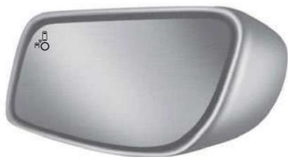
Cuando el sistema detecta un vehículo, se enciende un indicador de alerta en el espejo exterior del lado por donde viene el vehículo que se aproxima. Si activa el indicador de dirección para ese lado del vehículo, el indicador de alerta destella
