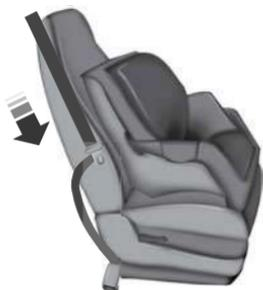
2. Después de colocar el asiento de seguridad para niños en la posición adecuada, hale hacia abajo el cinturón de hombros y luego agarre el cinturón de hombros y de cadera juntos detrás de la lengüeta del cinturón.
