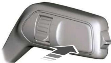
Mueva la palanca alejándola de usted para hacer funcionar el lavador de la ventana trasera. Cuando suelta la palanca, los limpiadores funcionan por un breve periodo.
