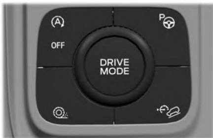
Gire el selector de modo de manejo en la consola central para seleccionar o cambiar un modo de manejo.
