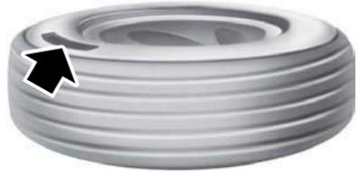
Los grados de calidad de las llantas se aplican a las llantas neumáticas nuevas para automóviles de pasajeros. Los grados de calidad se pueden encontrar, donde sea aplicable, en el costado de la llanta entre el borde de la banda de rodadura y el ancho máximo de sección. Por ejemplo: **Treadwear 200, Traction AA, Temperature A.**
