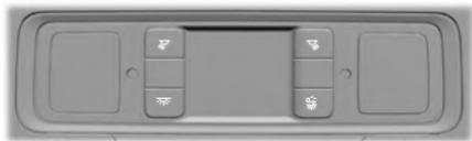
Los interruptores de las luces interiores delanteras se encuentran en la consola del techo.
