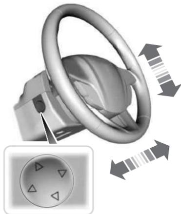
Utilice el control al costado de la columna de la dirección para ajustar la posición.
