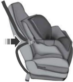
3. Mientras sostiene juntas las dos correas, pase la lengüeta a través del sistema de seguridad para niños de acuerdo con las instrucciones del fabricante. Asegúrese de no girar la correa del cinturón.
