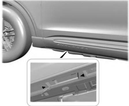
13. Coloque el gato en el punto de apoyo para el gato junto a la llanta que está cambiando. Gire la manija de la llave a la derecha hasta que la llanta desinflada se separe completamente del suelo.
