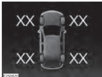
El sistema de control de presión de los neumáticos mide la presión de los neumáticos y envía las lecturas de la presión de los neumáticos al vehículo. Puede visualizar las lecturas de presión de los neumáticos a través de la pantalla de información. Véase **Información general** (página 91). La luz de advertencia de baja presión de los neumáticos se enciende cuando la presión está considerablemente baja. Si la luz de advertencia se enciende,
