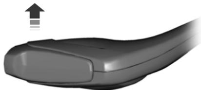
Empuje la palanca lejos de usted para encender las luces altas.
