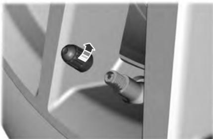
1. Quite la tapa de válvula de la válvula del neumático.
