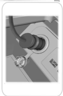
4. Enchufe el cable de alimentación en el tomacorriente de 12 voltios del vehículo.
