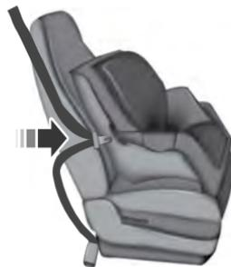
3. Mientras sostiene juntas las correas de hombro y caderas, pase la lengüeta a través del sistema de seguridad para niños de acuerdo con las instrucciones del fabricante de dicho sistema. Asegúrese de no girar la correa del cinturón.
