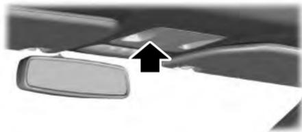
Los interruptores de las luces interiores delanteras se encuentran en la consola del techo.
