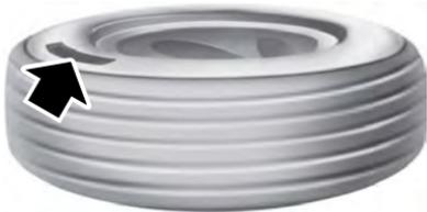
Los grados de calidad de los neumáticos se aplican a las llantas neumáticas nuevas para automóviles de pasajeros. La clasificación de calidad se puede encontrar, cuando corresponda, en el costado del neumático entre el reborde de la banda de rodadura y el ancho máximo de sección. Por ejemplo: **Treadwear 200, Traction AA, Temperature A.**
