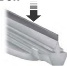
Pase la punta de los dedos sobre el borde de la plumilla para comprobar la aspereza.
