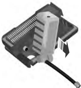
4. Gire el canister del sellador en 90 grados y jálalo, alejándolo de la carcasa para retirarlo.
