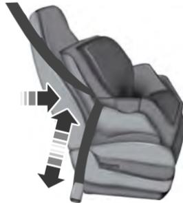
10. Antes de poner al niño en el asiento, intente inclinar con fuerza el asiento hacia delante y hacia atrás a fin de cerciorarse de que esté firmemente asegurado. Para comprobar lo anterior, tome el asiento en el trayecto del cinturón e intente moverlo de lado a lado y de adelante hacia atrás. No debe moverse más de 2,5 cm.
