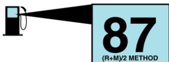
Su vehículo funciona con gasolina sin plomo del tipo normal con un octanaje mínimo (R+M)/2 de 87.
