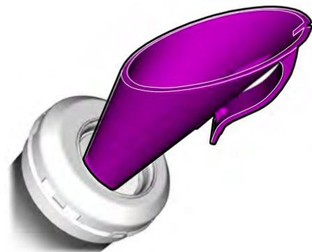
2. Inserte completamente el embudo de llenado de combustible en el orificio de la toma de combustible.
