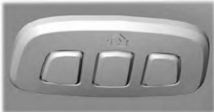
El sistema de apertura de puerta de garaje universal reemplaza al sistema portátil común con un transmisor de tres botones integrado en la visera del lado del conductor.
