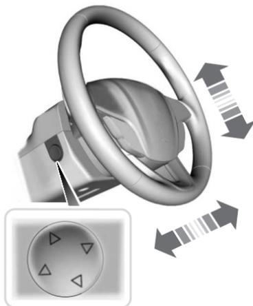
Presione la parte superior o inferior del control para mover el volante de dirección hacia arriba o hacia abajo.
