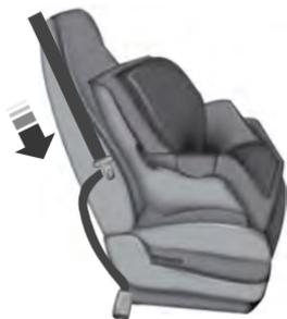
2. Después de colocar el asiento de seguridad para niños en la posición adecuada, jale hacia abajo el cinturón de hombros y de cadera juntos detrás de la lengüeta del cinturón.
