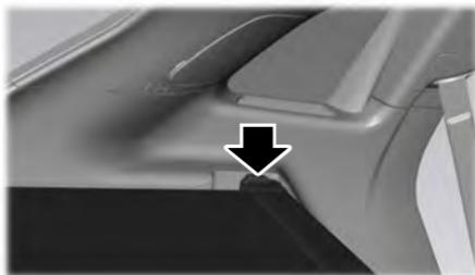
La pletina de la cubierta de equipaje se fija al panel de vestidura trasero.
