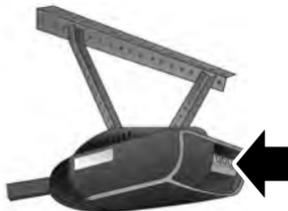
1. Oprima el botón de aprendizaje del motor del sistema de apertura de la puerta del garaje, tendrá 30 segundos para completar los siguientes dos pasos.
