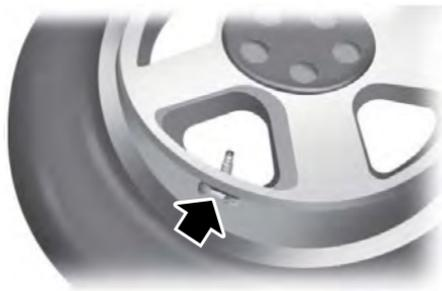
**Nota:** Todos los neumáticos de uso normal incluyen un detector de presión del neumático ubicado en el interior de la cavidad del conjunto de rueda y neumático. El sensor de presión está unido al vástago de válvula. El neumático cubre el sensor de presión, por lo que no se puede ver, a menos que quite el neumático. Tenga cuidado cuando cambie los neumáticos a fin de evitar dañar el sensor.
