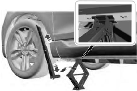
13. Las flechas representan los puntos de apoyo para el gato en la parte inferior del vehículo, en las ubicaciones que se muestran. La etiqueta de advertencia en el gato representa los detalles.
