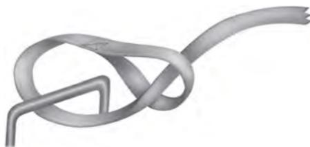
3. Busque los anillos de anclaje de carga traseros del lado izquierdo y del lado derecho. Pase el extremo con bucle de la correa de sujeción por el anillo de anclaje de carga. Enrosque el extremo sin bucle a través del bucle.
