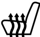
Presione el símbolo del asiento calefaccionado para recorrer las diversas configuraciones de calor y apagado. Mientras más indicadores se muestren, más caliente será la temperatura del asiento.
