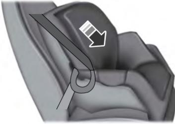
5. Para poner el retractor en el modo de bloqueo automático, agarre con la mano el cinturón de hombro y jale hacia abajo hasta extraer todo el cinturón.
