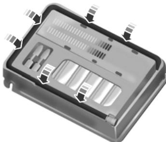
4. Coloque la manguera de doble propósito (tubo negro) alrededor del canal del fondo de la carcasa.
