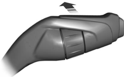
Mueva la palanca alejándola de usted para hacer funcionar el lavaparabrisas de la ventana trasera.
