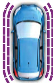
Los sensores laterales del sistema de aparcamiento se encuentran a ambos lados del vehículo en los parachoques delantero y trasero.
