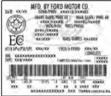
La etiqueta de certificación del cumplimiento de las normas de seguridad está adherida al pilar de bisagra de la puerta, al poste del pestillo de la puerta o al borde de la puerta que hace contacto con el poste del pestillo de la puerta, junto a la posición del asiento del conductor.
