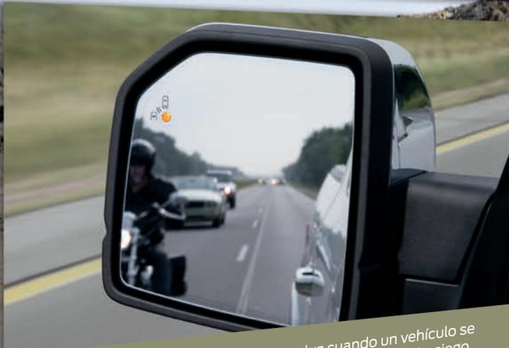
Los espejos exteriores te alertan con una luz cuando un vehículo se encuentra dentro del ángulo de visión conocido como punto ciego. La alerta de tráfico cruzado funciona conjuntamente con el sistema BLIS®, emitiendo una alerta cuando un vehículo pasa por detrás mientras retrocedemos.
