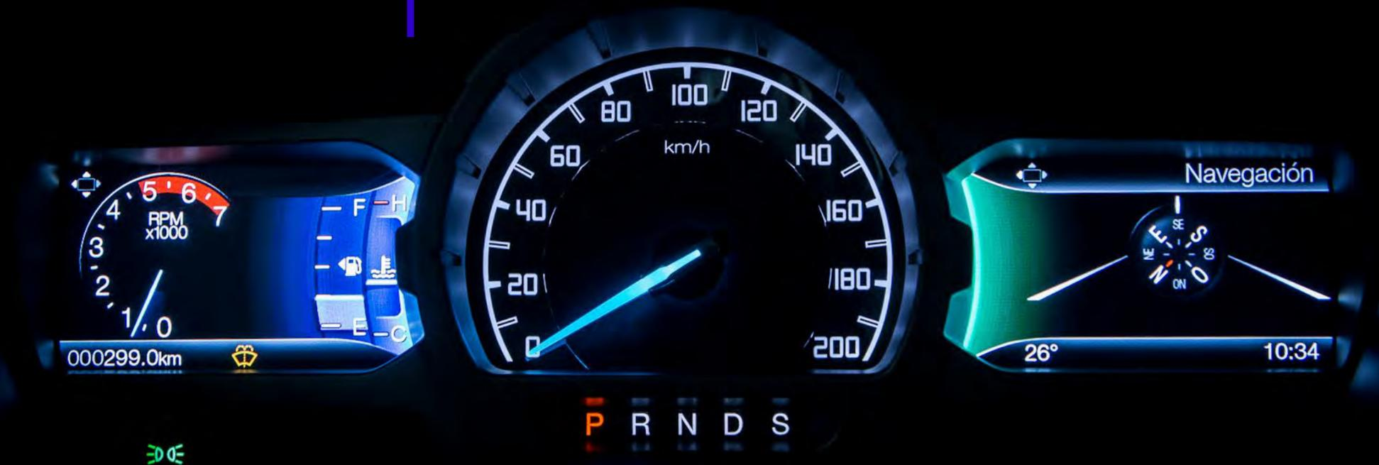
La pantalla derecha permite controlar los cuatro módulos de SYNC® 3.4 (teléfono, música, GPS y climatizador).
