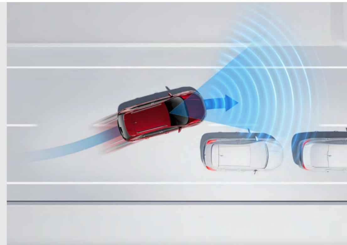
Te ayuda a evitar una posible colisión con un vehículo estacionado o que va más lento en frente tuyo. Adicionalmente, brinda asistencia en la dirección cuando no hay tiempo para evitar una colisión. Incluido en Ford Co-Pilot 360™.
