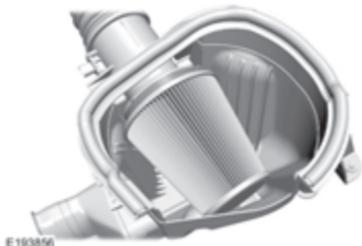
1. Afloje el tornillo de la abrazadera del filtro de aire lo suficiente para permitir que el filtro de aire deje salir fácilmente la carcasa del filtro de aire.
